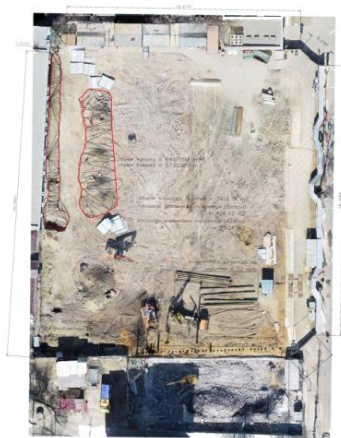
Рис. 2. Определение объема и нанесение результатов на ортофотоплан
