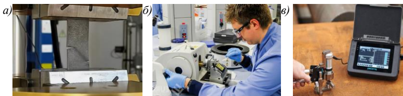
Рис. 1. Методы определения прочности стали: а – испытание пластины; б – структурный анализ стружки; в – испытания по методу Бринелля
