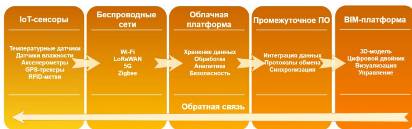
Рис. 1. Архитектура интеграции BIM и IoT для комплексного управления строительными объектами
