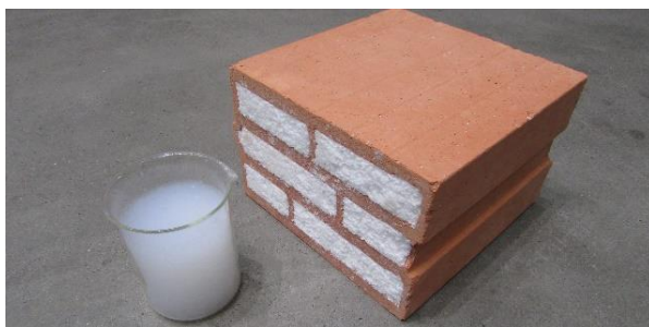
Рис. 1. «Аэробрикс» – керамический блок, полости которого заполнены аэрогелем
