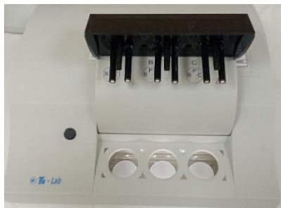
Рис. 1. Анализатор вольтамперометрический ТА-Lab с подготовленными электродами ХСЭ и АмЭ.
