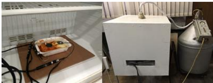
Рис. 3. Общий вид воздушной камеры шокового замораживания и криогенной азотной установки.
