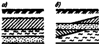
Рис. 1.1. Слоистое основание с согласным (а) и несогласным (б) залеганием грунтов.
