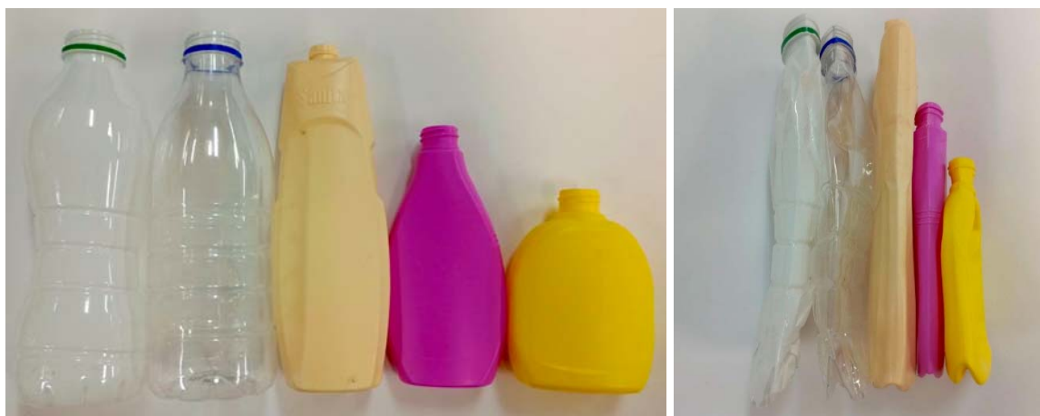
Рисунок 4.1 – Техногенные полимерные материалы до (а) и после (б) деформирования в пресс-валковом уплотнителе
