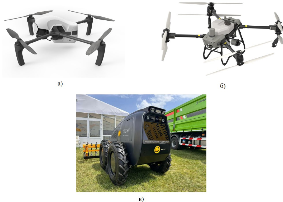
Рисунок 1.8 - Типология роботизированных и беспилотных систем а) Аэрофотосъемочный комплекс для оценки состояния посевов (NDVI) (Геоскан GEMINI). б) Тяжелый дрон для ультрамалообъемного внесения СЗР (DJI Agras). в) Автономная наземная платформа для механической прополки или скаутинга (Cognitive Pilot).
