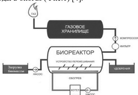
Рис.1. Схема простой биогазовой установки.
