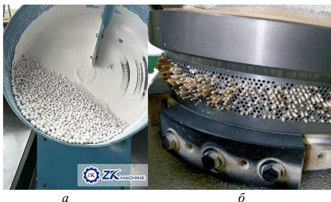
Рис. 2. Распространенные методы гранулирования: а – гранулирование методом окатывания; б – гранулирование прессованием.
