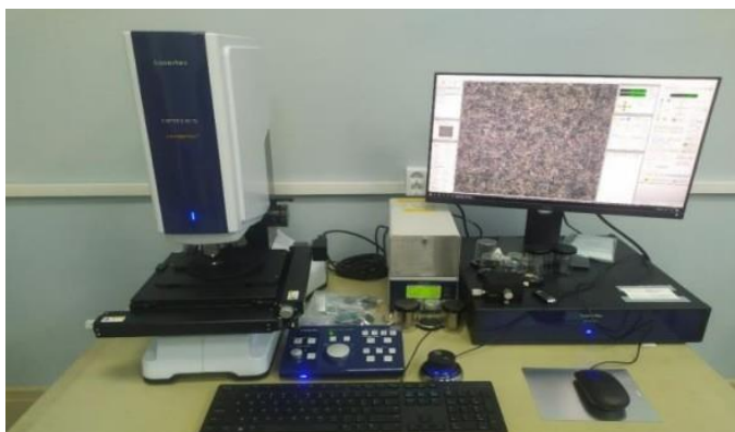
Рис. 3. Конфокальный сканирующий лазерный микроскоп Optelics Hybrid Lasertec (Япония, 2021).
