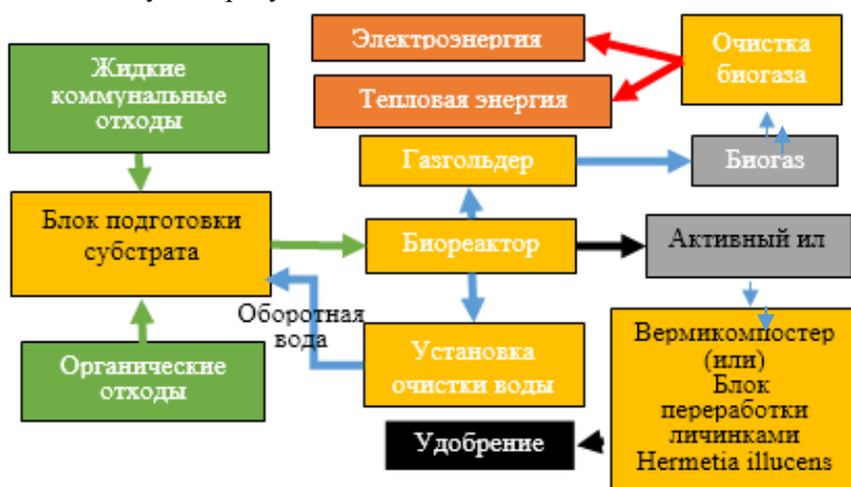
Рис. 1. Технологическая схема экспериментальной установки по утилизации канализационных стоков.
