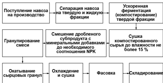
Рис. 1. Блок-схема производства гранулированных органоминеральных удобрений.
