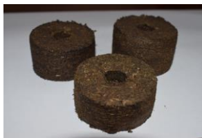
Рис. 5. Топливные брикеты из продуктов переработки канализационных отходов.
