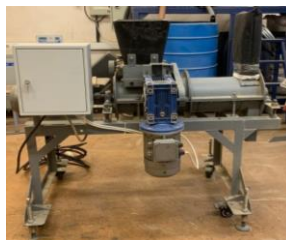
Рис. 3. Дробилка для измельчения органических отходов.
