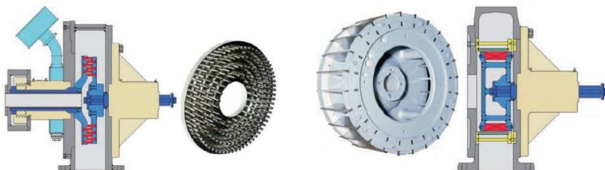
Рисунок 1.10 Схемы мельницы «Condux» с различными видами рабочих органов: а) с штифтовыми роторами; б) с воздуховым ротором
