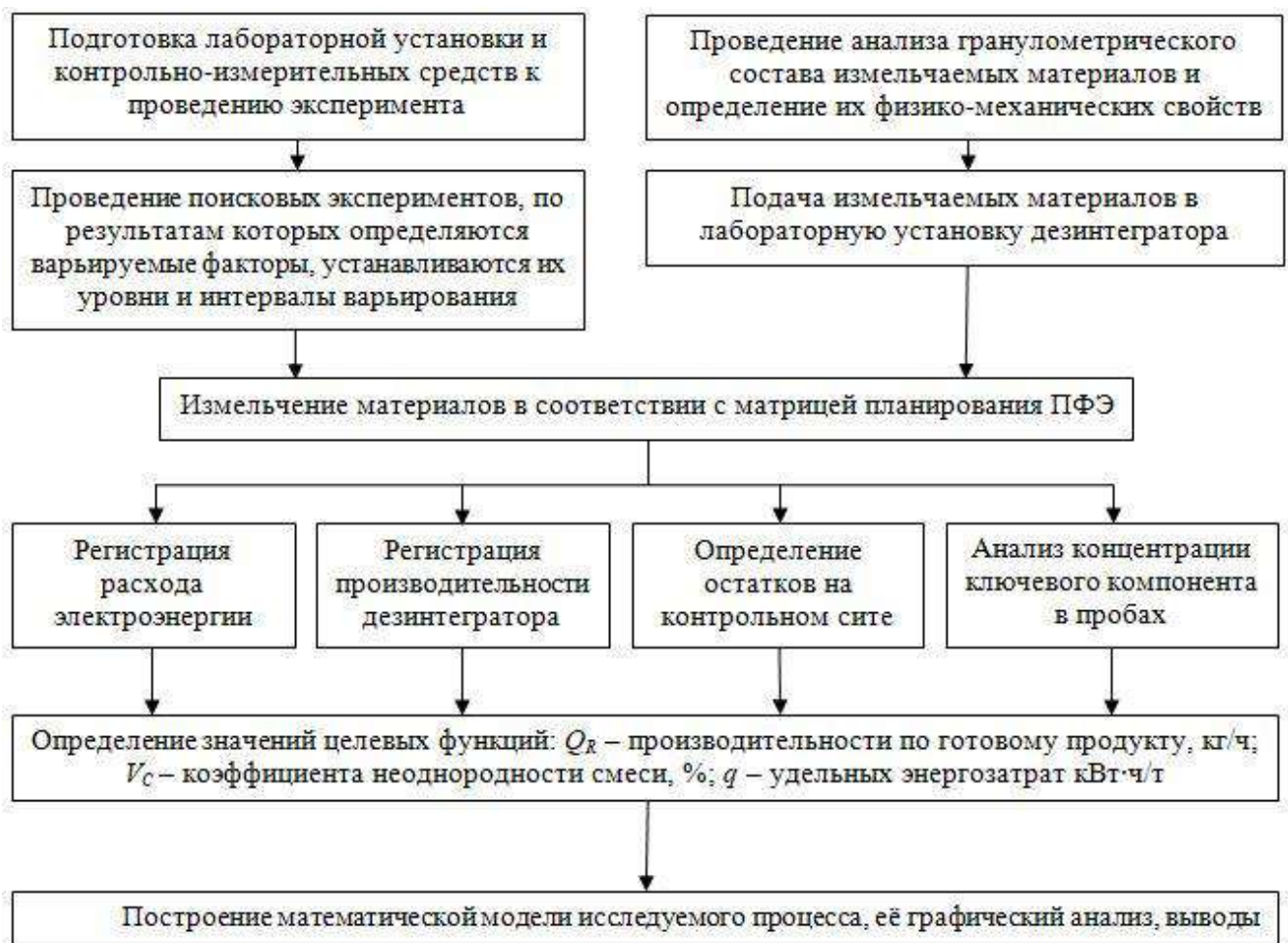
Рисунок 3.1 Схема последовательности проведения экспериментальных исследований процесса совместного измельчения компонентов в лабораторной установке дезинтегратора
