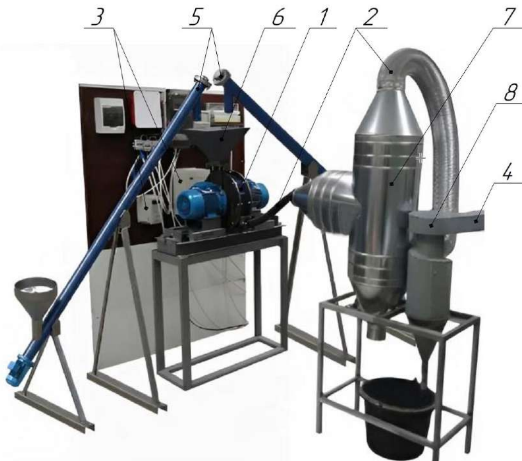
Рисунок. 3.7 Лабораторный измельчительный комплекс: 1 – дезинтегратор; 2 – патрубки соединительные; 3 – частотные преобразователи; 4 – патрубок отводящий; 5 – шнековые транспортеры; 6 – загрузочный бункер; 7 – пылевая камера; 8 – циклон
