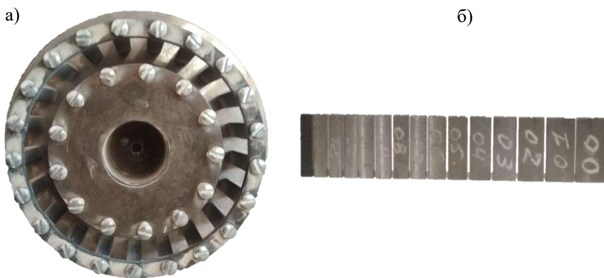
Рисунок. 3.6 а) малый ротор; б) набор ударных элементов
