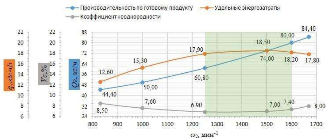
Рисунок 4.14. Графики зависимости Q_R, q, V_C = f(\omega_2)
