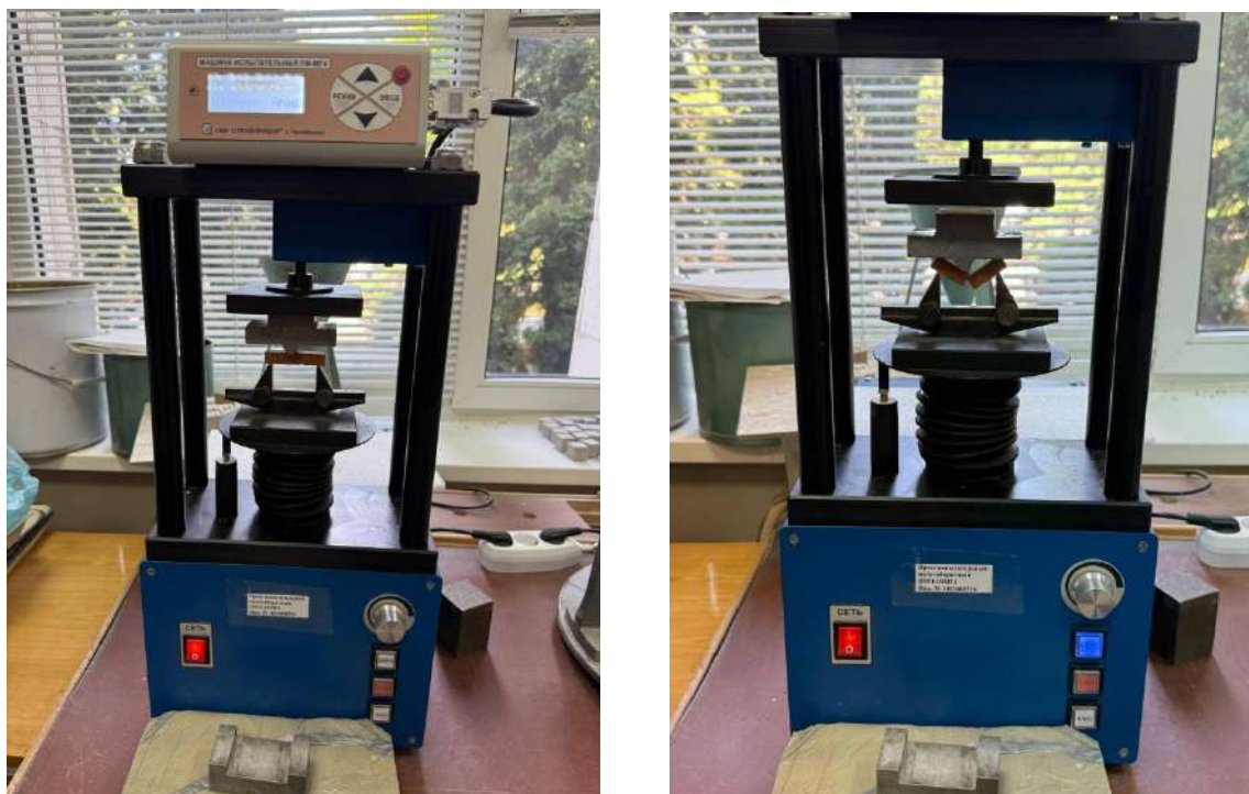
Рисунок 5.7. Малогабаритный испытательный пресс ПМЭ-10МГ4 с образцом керамического кирпича при испытании на изгиб
