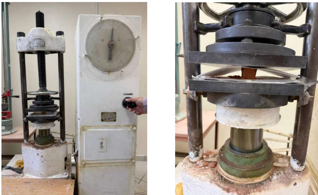
Рисунок 5.6. Гидравлический пресс марки П-10 с образцом керамического кирпича при испытании на сжатие
