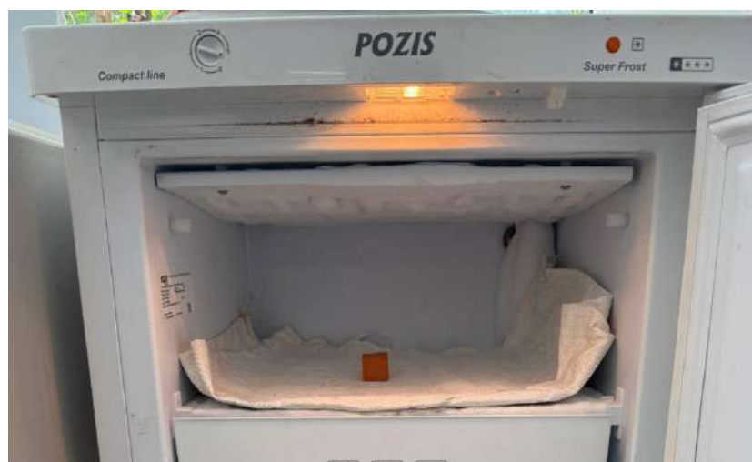
Рисунок 5.8. Морозильная камера POZIS FV-108 с образцом керамического кирпича при испытании на морозостойкость
