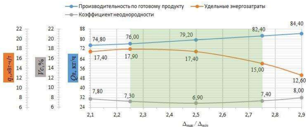
Рисунок 4.15. Графики зависимости Q_R, q, V_C = f(\Delta_{\max} / \Delta_{\min})
