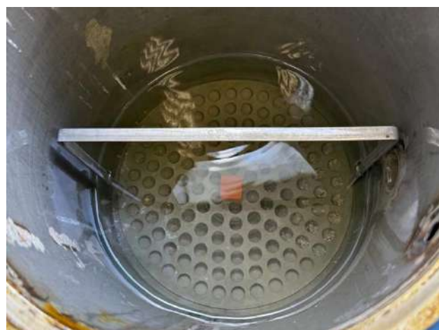
Рисунок 5.9. Устройство экспресс контроля водопоглощения с образцом керамического кирпича
