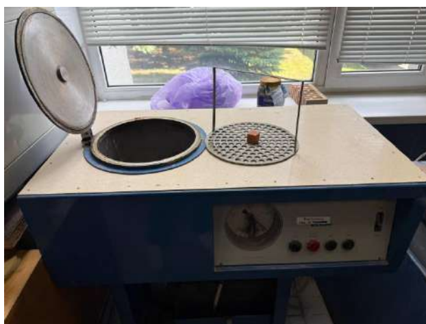
Рисунок 5.9. Устройство экспресс контроля водопоглощения с образцом керамического кирпича
