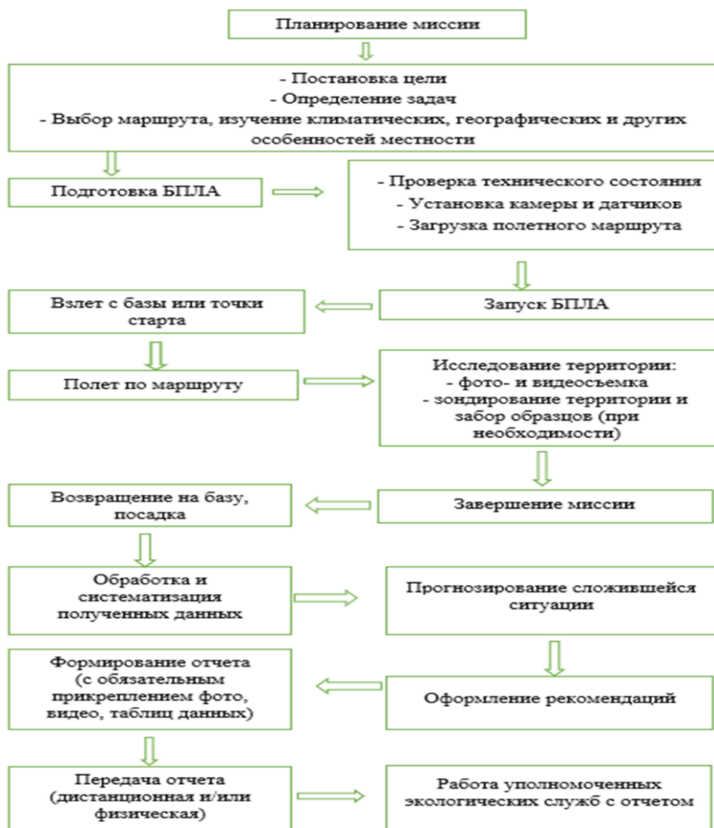
Рис. 1. Блок-схема применения БПЛА при мониторинге состояния окружающей среды
