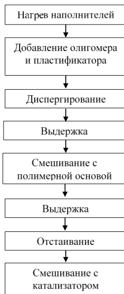
Рис. 1. Технологическая схема производства заливочного силиконового компаунда
