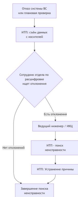
Рис. 1 Схема взаимодействия инженерно-технического персонала и инженеров по полетной информации при неисправности воздушного судна
