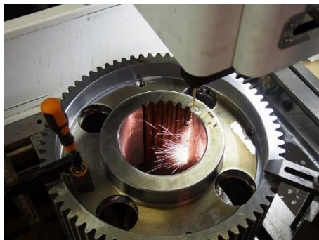
Рис. 1. Процесс вырезания шлицов в зубчатом колесе
