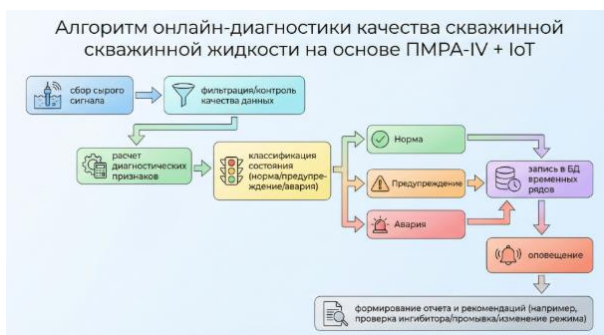
Рис. 2. Алгоритм онлайн-диагностики качества скважинной жидкости на основе ПМРА-IV и IoT-технологий
