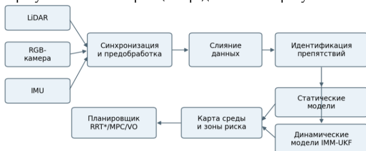
Рис. 1. Архитектура мультисенсорной идентификации препятствий и планирования траектории БПЛА
