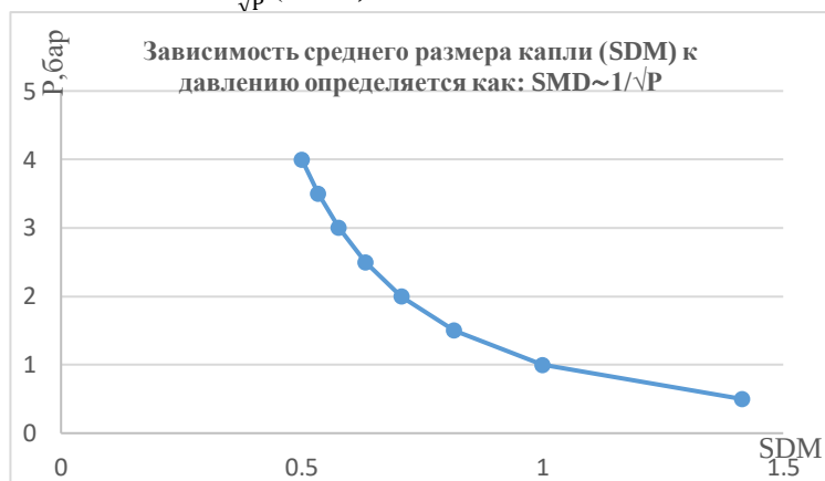
Рис. 3 Зависимость между средним размером капли и давлением
