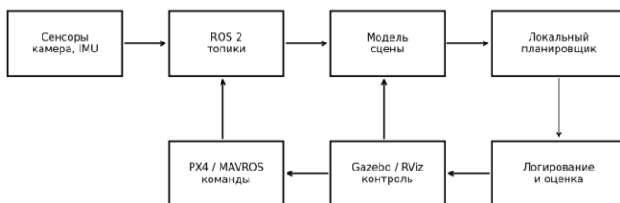
Рис. 1 - Архитектура программно-экспериментального контура БПЛА
