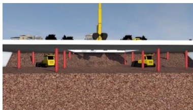
Рис. 1. Котлован для подземной парковки
