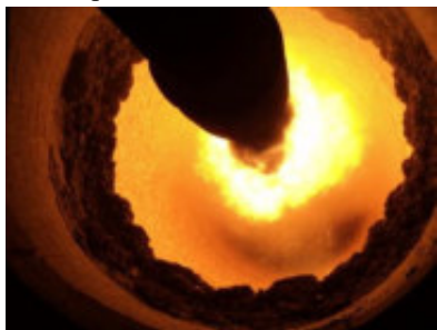
Рисунок 3 - Зольное кольцо на горячем обресе печи
