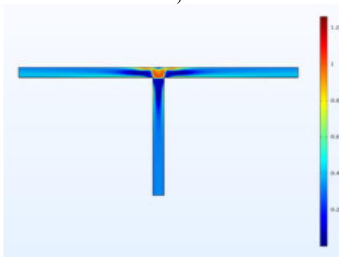
Рисунок 2 - Распределение скорости воздуха в равносторонней крестовине: а) в поперечном сечении (плоскость XY); б) в продольном сечении (плоскость YZ); в) в продольном сечении (плоскость XZ)
