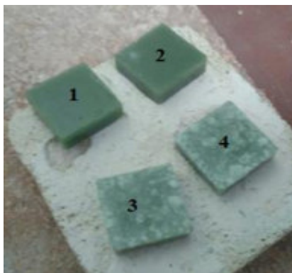
Рисунок 2 - Термообработка образцов при T = 725\text{ }^{\circ}\text{C} :
