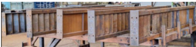
Рисунок 1 - Общий вид опытных образцов в процессе сбор-сварки
