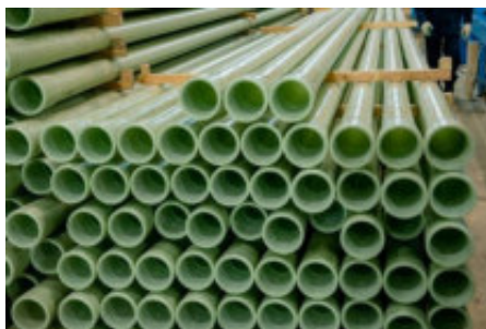
Рисунок 1 – Фото стеклокомпозитных труб, изготовленных методом периодической намотки
