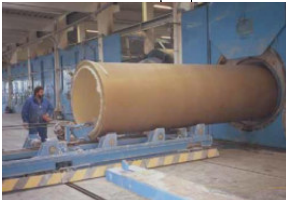
Рисунок 3 – Фото выгрузки трубы из установки центробежного литья
