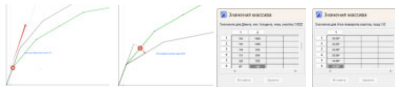
Рисунок 3 - Инструменты автоматизации первичного документирования и последующей периодической актуализации положения и развития дефекта: подвижные маркеры, позволяющие удлиняют и поворачивают каждый из участков трещины; массив данных с количественными характеристиками участков дефектов, используемый при ретроспективном анализе его развития
