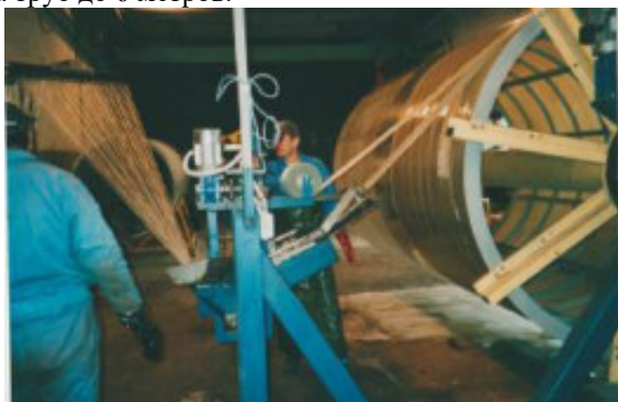
Рисунок 2 – Фото машины периодической намотки для труб по ГОСТ Р 55075
