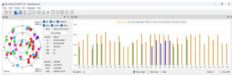
Рисунок 3 - Расположение спутников (слева) и уровень сигнала (справа) во время эксперимента
