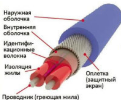
Рисунок 1 - Резистивный греющий кабель
