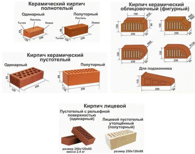
Рис. 1. Виды мелкоштучных изделий для кладки стен
